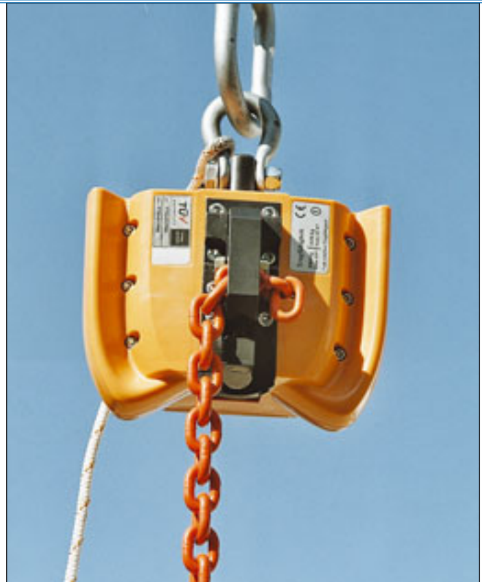
Fix-de-Fix von Hetronic: Im Inneren befindet sich ein Empfangsteil zum Lösen des Aufnahmebügels per Funk (Quelle: Zopf GmbH)
