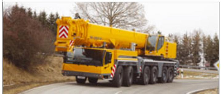
Liebherr bringt einen neuen 350-Tonner Sechssacher auf den Markt. Der LTM 1350-6.1 bietet mit seinem 70-Meter-Teleskopausleger ein Plus von zehn Metern im Vergleich zum Vorgänger. Auch die Tragkraft wurde deutlich gesteigert. Der neue LTM 1350-6.1 ist laut Liebherr der stärkste Sechssacher im Markt. Zusätzliche Traglaststeigerungen resultieren aus der Y-Abspannung, die in vielen Bereichen eine Verdopplung der
