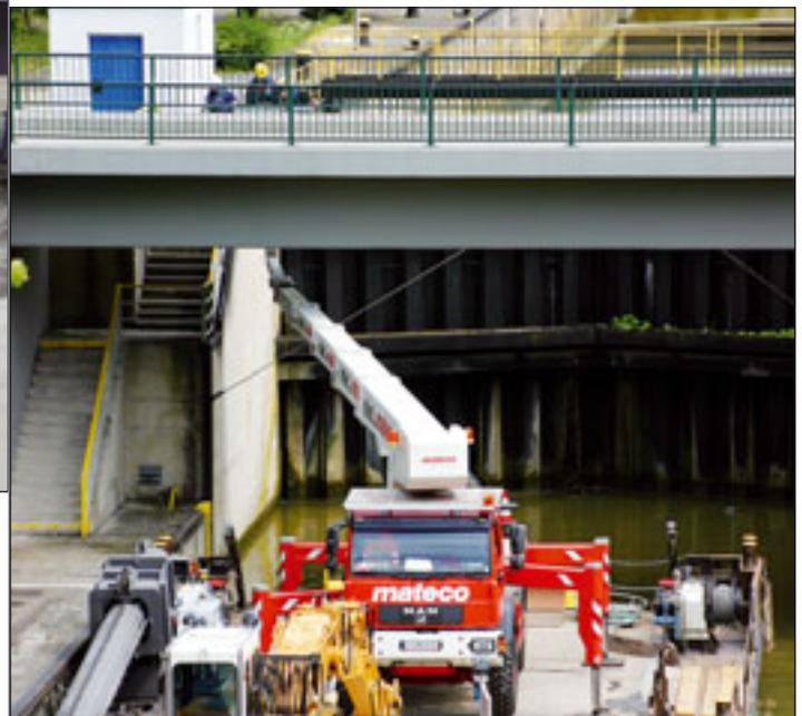
Eine Bison Palfinger TKA 35 KS aus dem Pool von Mateco hat den Schritt aufs Wasser gewagt. Sie wurde auf ein schwimmendes Ponton angetrieben. Mit einer Arbeitshöhe von 35 Metern und knapp 30 Metern seitlicher Reichweite bietet sich die Bühne dafür an, um Bauwerke von Binnengewässern unter die Lupe zu nehmen. Das Wasser- und Schiff-
