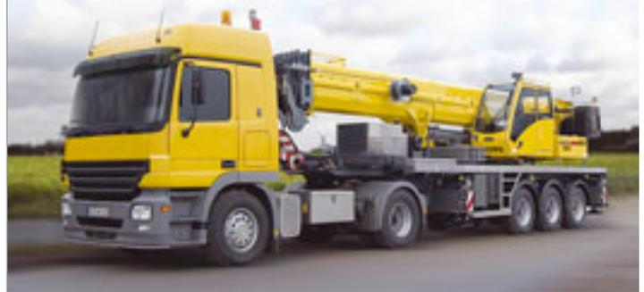
Nun sind wir im Bilde: Zum ersten Mal ist Groves neuer GSK55 im Foto zu sehen. Der Clou des neuen Konzeptes: Der 55-Tonner ist mit einem speziell konstruierten LKW-Fahrwerk kombiniert, welches als Anhänger dient. Als Zugfahrzeug kann der Kunde einen beliebigen LKW benutzen. Ein zweiachsiges Zugfahrzeug bringt Achslasten von unter neuen
