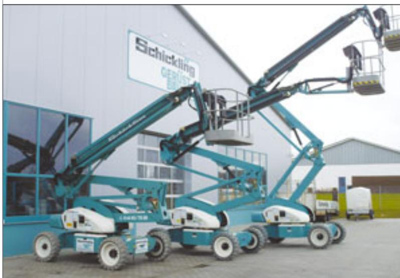
Zwei Nifty HR21DE sind an Schickling mit Sitz in Visbek, Niedersachsen gegangen. Ausschlaggebend waren die kompakten Maße der Selbstfahrer: nur 2,25 Meter breit, fünf Meter Transportlänge – bei 12,60 Meter Reichweite. Mark van Oosten,
