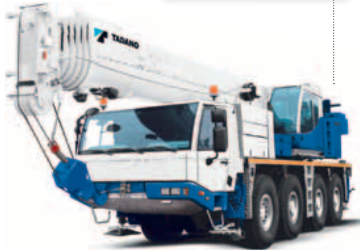
Der ATF 70G-4 in der Variante mit 52,1 Meter langem Hauptausleger
