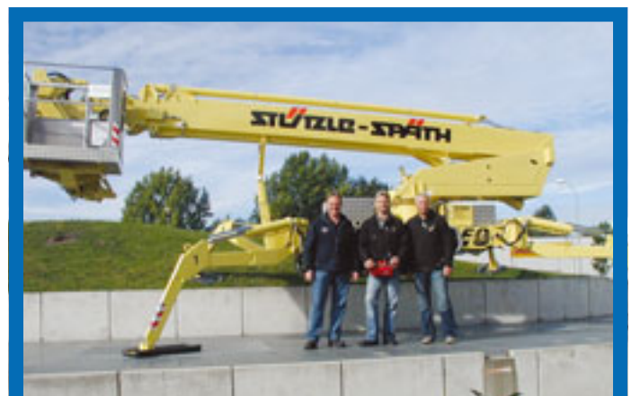
Verstärkung für Stützle-Späth: Die Teupen Leo 30 T wurde auf die Wünsche des Kunden angepasst. Bei der 30 Meter-Raupenbühne wurden unter anderem zusätzliche Abdeckungen und Schutzhauben aus Aluminium-Riffelblech beziehungsweise aus verzinktem Stahl umgesetzt.
