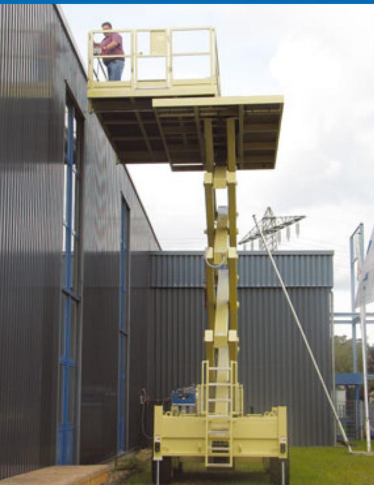
H.A.B. hat eine neue 16-Meter-Scherenbühne für Tunnel- und Fassadenarbeiten entwickelt. Dank 1,20 Meter seitlichem Ausschub kann über Beete oder ähnliches hinweg gearbeitet werden. Die ersten vier Maschinen gehen an das französische Unternehmen Carriescopic.
