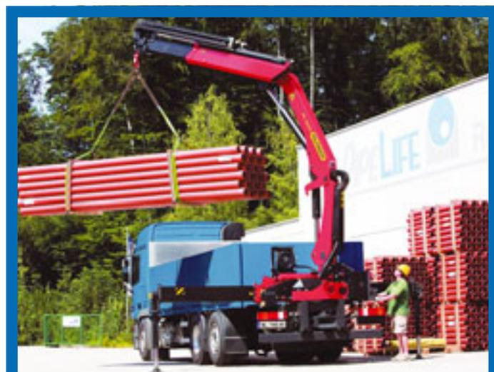
Einen ganzen Schwung neuer Modelle aus der „High Performance“-Baureihe hat Palfinger auf der Matexpo in Belgien vorgestellt: drei Modelle in der 13/14m-Klasse und im Bereich 16- bis 18mt ebenso drei Neuheiten, darunter der PK 16001 (siehe Bild). Als Neuheit bei den Knickarmkranen kommt das System Single Link Plus: Es ermöglicht die Überstreckung des Knickarms um 15 Prozent.
