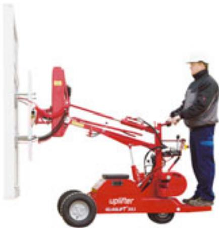
menkonstruktion, maximierte das Gegengewicht und fügte einen neuen hydraulischen Kippzylinder hinzu – und heraus kam der Glaslift 351 mit einer Lastenkapazität von bis zu 350 Kilogramm.
