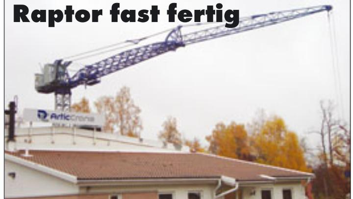
Der Raptor 84 von Artic Crane aus Schweden soll demnächst in Betrieb gehen, und zwar bei City Lifting aus London. Auf den Vertikal Days im Juni war die Krankabine bereits zu sehen. Seitdem ist der Turmdrehkran aus Schweden einem ausführlichen Testprogramm unterzogen worden. Konzipiert wurde der Kran
