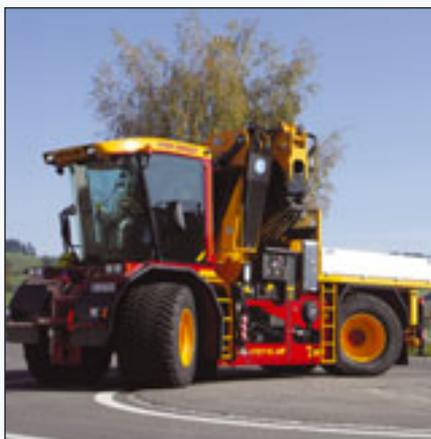
Effer 655 Heavy Duty, hat eine Drive“ ausgestattet. Somit ist das horizontale Reichweite von 34,2 Metern mit 470 Kilogramm Hubkraft. Wie alle Effer-Krane ist er mit dem patentierten Auslegersystem Line-Teleskop und „Wind & Fahrzeug sowohl für die Stadt mit ihren schmalen Gassen als auch fürs Gelände und Off-Road ein-satztauglich. Die Weltpremiere des Fahrzeugs fand in Hannover statt.
