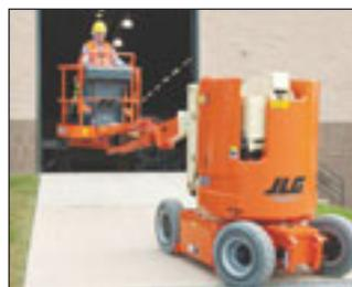
Die verbesserte Version der Gelenkteleskopbühne E300 ist zu sehen. Vor allem im Bereich der Sicherheit wurde vieles verbessert, bei den Reifen angefangen bis hin zum Schlaglochschutz. Neue Batterien erzielen längere Arbeitszyklen.
