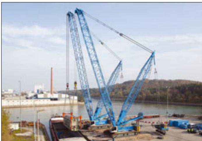
Die Firma Felbermayr wurde beauftragt, im Hafen von Nürnberg einen defekten knapp 400 Tonnen schweren Trafo aus einem Lastschiff zu heben. Dabei kamen zwei Liebherr-Raupenkrane LR 1300 im Tandemhub zum Einsatz. Der Trafo wurde mittels Schwerlastschiff am Hafen angeliefert und musste auf einen Schwertransporter
