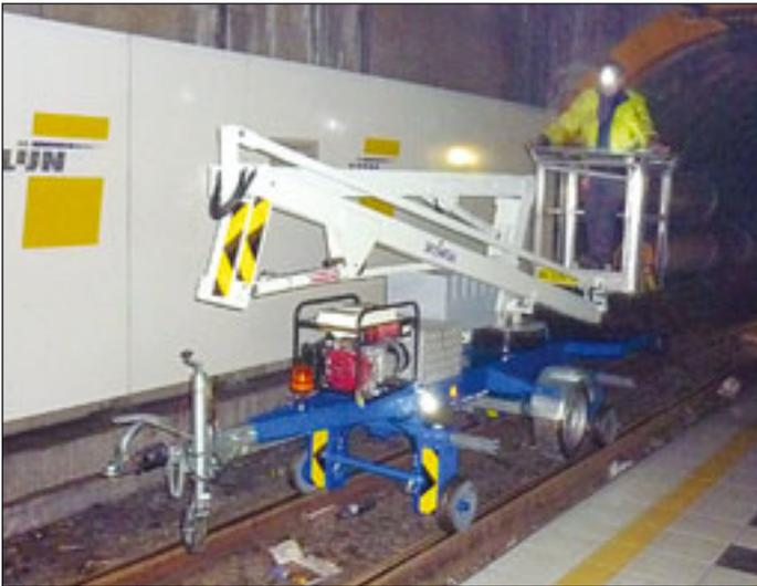
Das belgische Unternehmen Sky-High bringt zwei neue Nischenmodelle heraus. Die Sky-High ST 1100 Rail kann dank verstellbarer Spurbreite auf verschiedenen Gleisen zum Einsatz kommen: neben Eisenbahn- auch auf Straßenbahnschienen. Das Gerät verfügt
