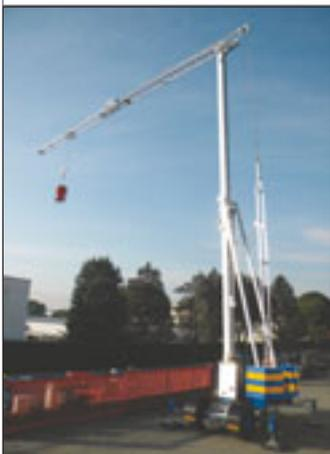
beträgt 20 Tonnen und er erreicht eine Ausladung von bis zu 80 Meter. Der Kran ist in drei Varianten erhältlich.
