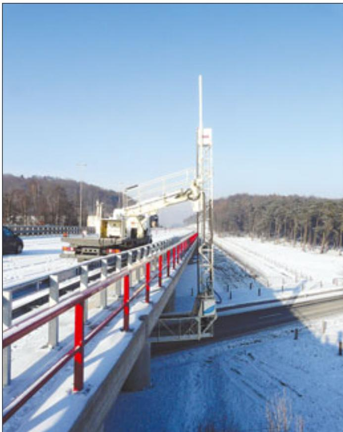
Seit dem Jahresbeginn ist eine neue Barin-Maschine hierzulande im Einsatz. Das Brückenuntersichtgerät mit der Typenbezeichnung ABC 110/130/150/LS, aufgebaut auf Mercedes Benz Axor, gehört der Theo
