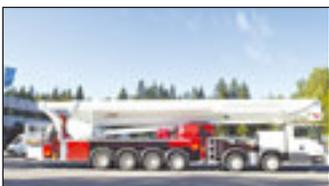
Spektakuläre Premiere bei Bronto: Der finnische Hersteller von LKW-Bühnen und Hubrettern präsentiert seinen neuen „Höhenweltrekordler“ aus der HLA-Reihe mit 112 Metern Arbeitshöhe. Bei 90 Metern sollen 25 Meter Reichweite drin sein. Die S 112 HLA ist auf Mercedes Benz 76.60 Allrad-Chassis aufgebaut. Die Gesamtlänge liegt um 19 Meter, die Transporthöhe unter vier Meter. Auch eine S 104 HLA steht vor Ort.
