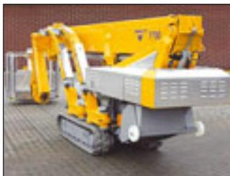
Präsentiert wird die neue Raupenbühne 3700 RBDJ: eine kompakte Teleskoparbeitsbühne mit einer Arbeitshöhe von 37 Metern, einem beweglichen Korbarm
