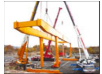
Der Hebezeugspezialist präsentiert eine komplette Zweischienenkatze in Drehwerksausführung mit von 2 x 10 Tonnen Tragkraft. Alle Bewegungen sind frequenzgesteuert. Zudem werden die kompakten Elektroseilzüge aus eigener Fertigung gezeigt.
