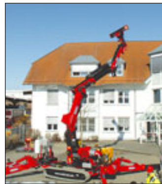
Überstreckbarer Knickarm und Vier-Achsen-Manipulator sind weitere besondere Details
