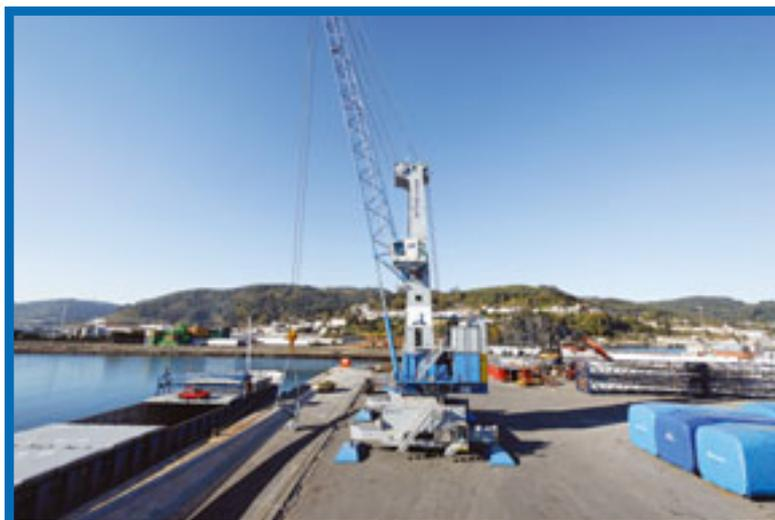
Ein Modell 4 Kran in der Variante G HMK 4406 von Gottwald wird im finnischen Hafen Hanko für den Umschlag von Rohren, die für die neue Ostsee-Pipeline bestimmt sind, eingesetzt. In dem Zwischenlager westlich von Helsinki werden insgesamt 40.000 Rohre umgeschlagen.
