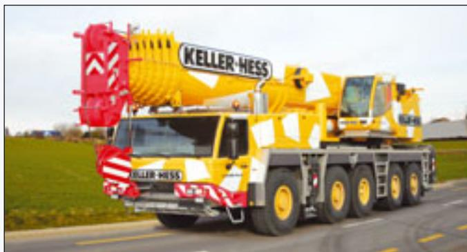
Einen ATF 220G-5 von Tadano Faun hat die Keller+Hess AG in Empfang genommen. Der sieben-teilige 68-Meter-Ausleger ist innerhalb von sieben Sekunden durch das 1-Zylinder-Teleskopiersystem einsatzbereit. „Das laufuhige Fahrverhalten des ATF 220G-5 ist beeindruckend“, sagt Kranfahrer Patrick Geyer und fügt hinzu: „Der Unterwagen ist extrem verwindungssteif im abgestützten Zustand.“ Sein Vorgesetzter Andreas Keller hebt wei-
