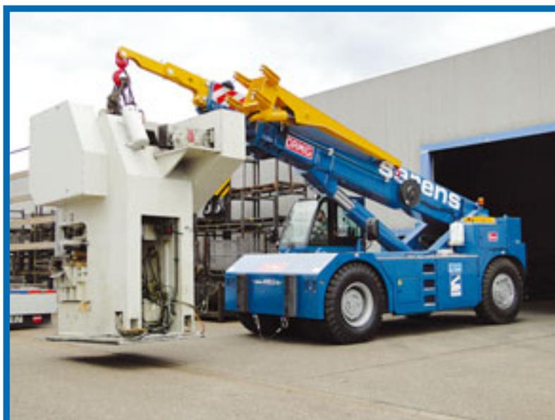
Für das interne Handling von Lasten hat sich der belgische Kran-dienstleister Sarens mit einem elektrisch angetriebenem Pick&Carry-Kran von Ormig verstärkt. Es bietet Traglasten von maximal 33 Tonnen, bei kompakten Abmaßen.
