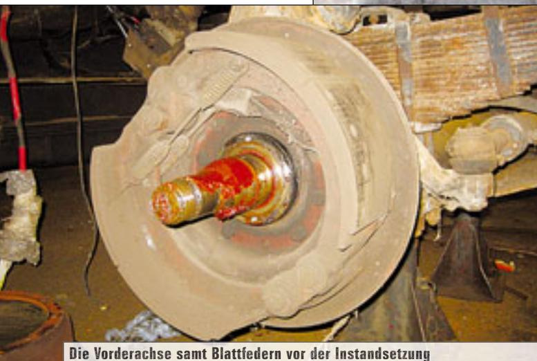
Die Vorderachse samt Blattfedern vor der Instandsetzung
