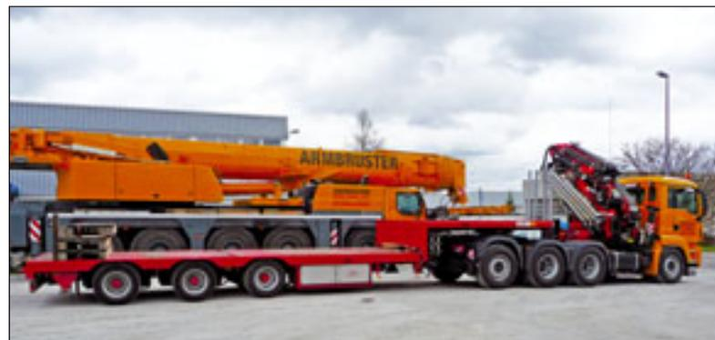
Wechselbar ist dieser Fassi-Kranaufbau
