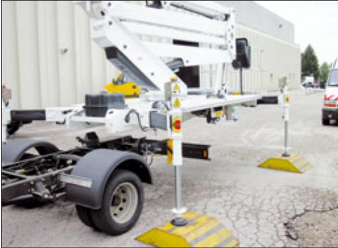
Der italienische Arbeitsbühnenhersteller Isoli hat eine 21-Meter-LKW-Bühne des Typs PNT 210J mit einer etwas anderen Ausstattung versehen. Der Kunde wollte den 3,5-Tonner sowohl als Arbeitsbühne als auch als Pritschenwagen samt Ladekran einsetzen. Isoli löste das Problem, indem es Bühnenaufbau und Pritschenwagen abnehmbar gestaltete, sodass der Kunde jederzeit auf das
