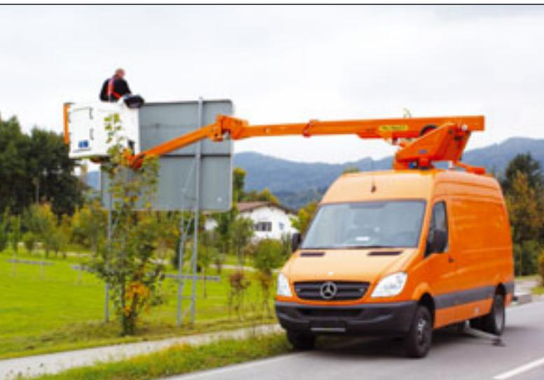
Palfinger hat auf den Messen IFAT und IAA das neue Hubarbeitsbühnen-Konzept der PD-Reihe präsentiert, bei dem die Arbeitsbühne auf einen Kleintransporter montiert ist. Dem Unternehmen zufolge rief das Konzept reges Interesse hervor, da die Bühnen schon ab einem 3,5-Tonnen-Fahr-
