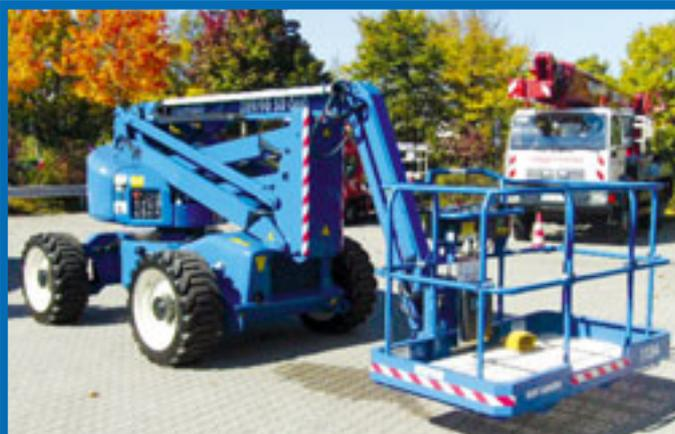
Zwei Gelenkteleskopbühnen vom Typ Snorkel A 46 JRT hat Snorkel Deutschland / Hubarbeitsbühnen Bielefeld an die Firma Roggermaier ausgeliefert. Die A 46 JRT hat eine Arbeitshöhe von 16,30 Metern, 4x4-Antrieb und Pendelachse. Das hat Roggermaier – neben dem Service – überzeugt.
