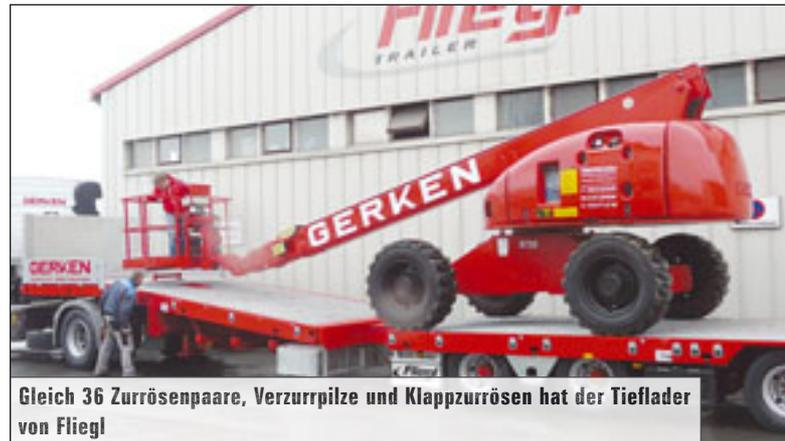
Gleich 36 Zurrösenpaare, Verzurrpilze und Klappzurrösen hat der Tieflader von Fliegl
