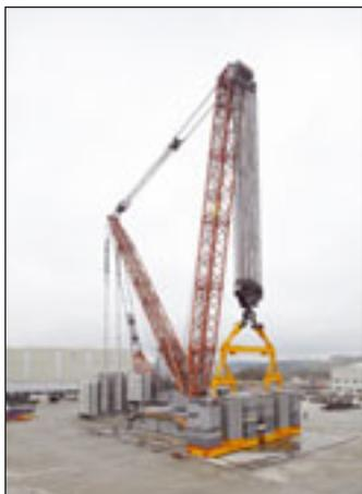
Freude in Ehingen: Ende November hat der auf der bauma vorgestellte LR 13000 erfolgreich eine Testlast von 3.371 Tonnen gehoben. Er hob die Testlast mit 60-Meter-Hauptausleger auf 16 Meter Radius. Der neue Raupenkran-Gigant ist eigentlich „nur“ auf 3.000 Tonnen Traglast ausgelegt. Damit übersteigt die Testlast die vorgesehene Höchstkapazität deutlich, um gut zwölf Prozent. An wen das erste Exemplar gehen wird, ist noch unklar.
