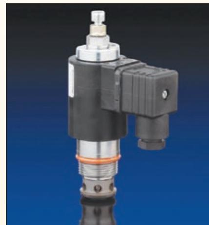
Zustand leakagefrei und erhält so den Druck ohne Verluste aufrecht. Typ EMC ist auf einen Volumenstrom bis max. 80 l/min und Betriebsdruck bis max. 250 bar ausgelegt.
