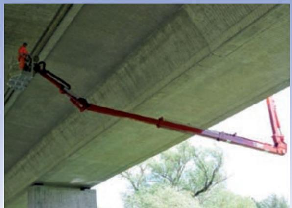
Das BARIN Gerät für den Zugang zu Unterführungen
