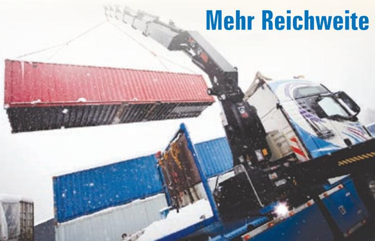
Hiab hat seinen Schwerlastkran XS622 weiter entwickelt. Er bietet ein neues Auslegersystem und neue Zylinder, noch bessere Kupplungen und Dichtungen. „Höchste Präzision ist bei großer Reichweite nicht immer einfach zu gewährleisten. Nicht so beim Hiab XS 622, denn dieser Kran ermöglicht selbst bei maximaler horizontaler Auslage exaktes Arbeiten“, sagt Mikael Rietz, Vice President für Ladekrane bei Cargotec.
