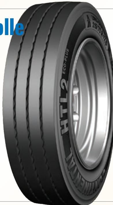
sionen 205/65 R.17.5, 215/75 R 17.5 und 235/75 R 17.5. Wie alle Reifen der zweiten Generation verfügen die runderneuerungsfähigen Volumensattelaufleger- und Tiefladerreifen über die innovativen, konstruktiven Merkmale der Continental-Goods-Karkasse wie vierlagige Dreiecksgürtel, verstärkte Stahlcordwülste und AirKeep-Innenseele gegen Druckluftverlust.
