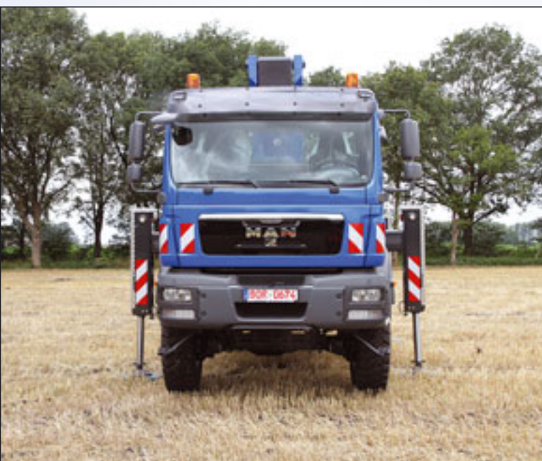
Für seine T-Baureihe, die um die neue T 285 ergänzt wurde, hat Ruthmann ein neues Stützenkonzept entwickelt. Obwohl die Stützen nur um 50 Zentimeter ausgefahren werden, wird die volle Reichweite erzielt.
