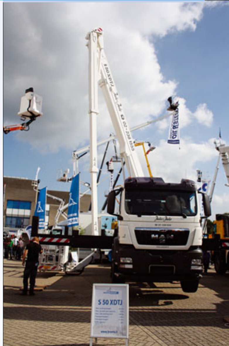
Die erste Bronto S 50 XDTJ, aufgebaut auf einem MAN TGS 26.400 6x4
