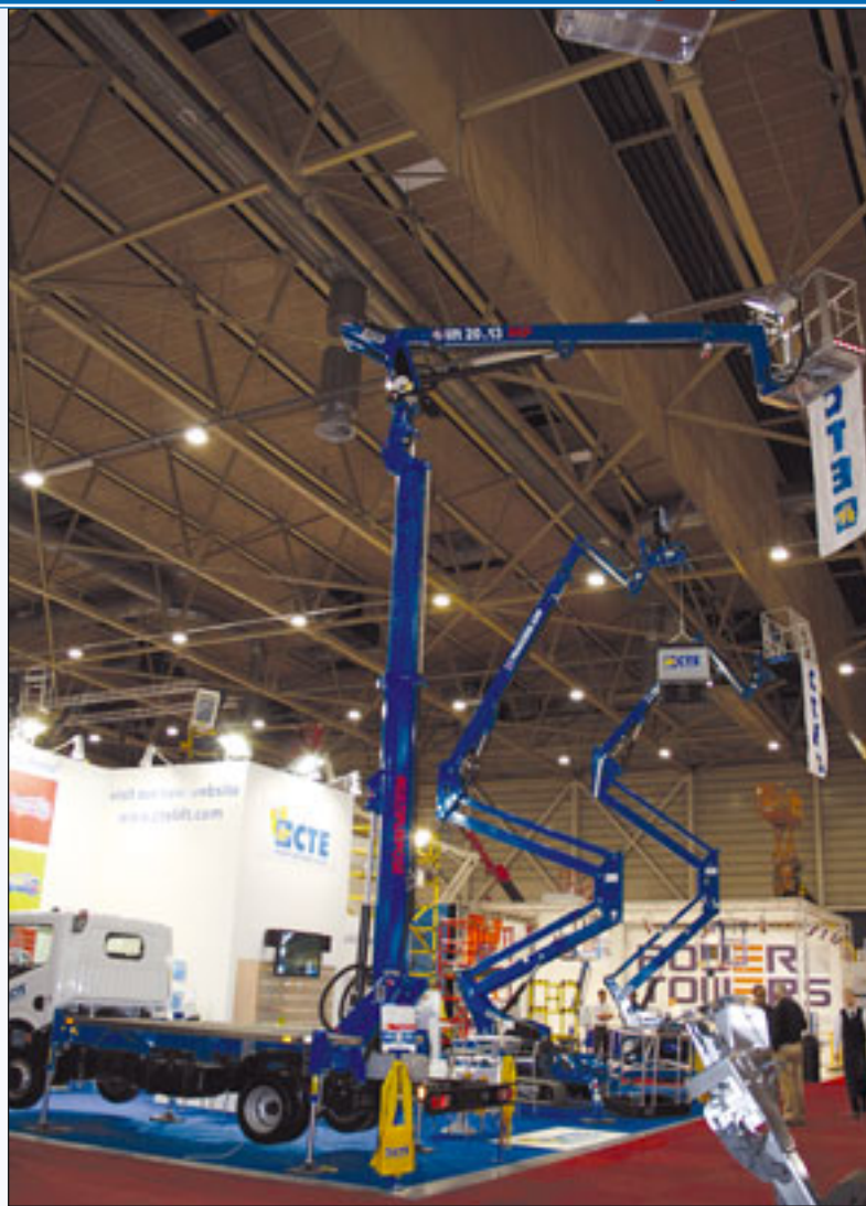
Der Drehpunkt der B-Lift 20.13 MP ist auf dem unteren Teleskop angebracht
