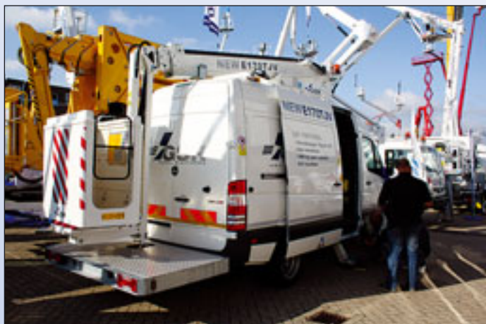
Eine der drei Neuheiten von GSR, die E170TJV. Die 16,6 Meter-Bühne auf Kastenwagen ist gegen 1.000 Volt isoliert.
