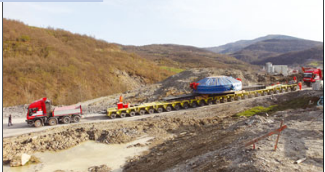
Auf einen 25-achsigen Schwerlasttransporter von Goldhofer wurde dieser 235 Tonnen Schneidradantrieb durch Oberitalien transportiert
