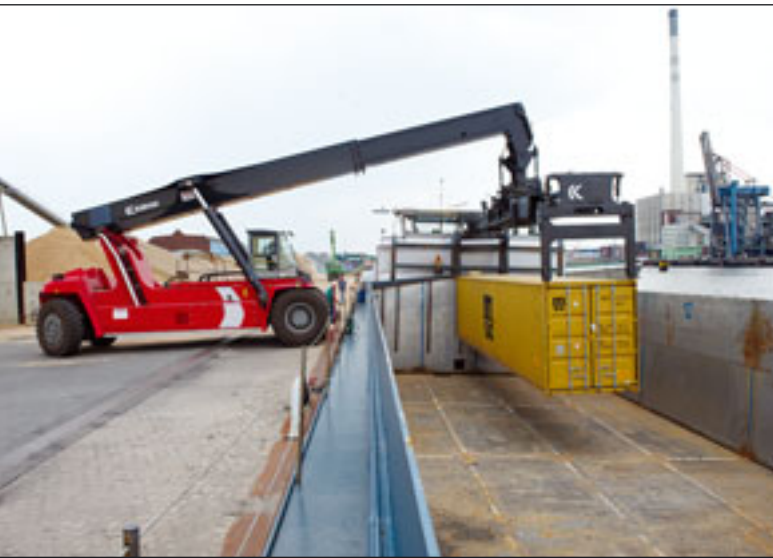
Addicks & Kreye setzt auf den 45-Tonnen-Bargehandler von Kalmar
