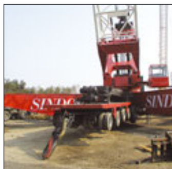
Der Kran ohne seine Zugmaschine
