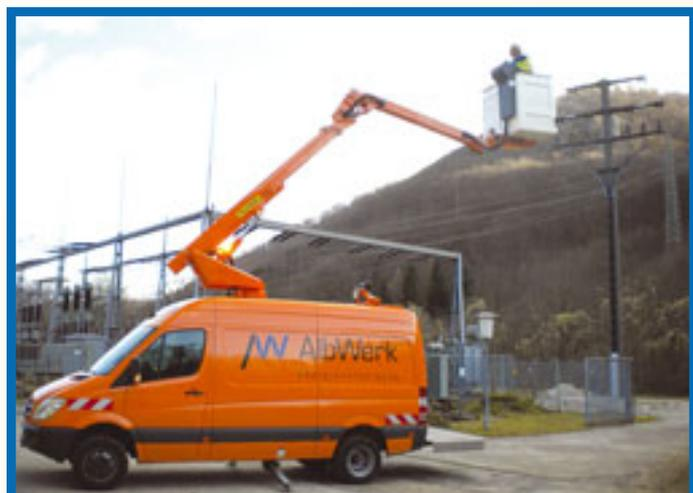
Um die Stromleitungen und die Straßenbeleuchtung im gesamten Netzgebiet von über 600 Quadratkilometern instand halten zu können, hat das Aluwerk Geislingen seinen Fuhrpark um eine Palfinger PD 140V erweitert. Das Haupteinsatzgebiet im Arbeitsalltag ist fast ausschließlich die Wartung und Instandhaltung der Straßenbeleuchtung. Viel Platz im Fahrzeug wird daher für Werkzeug und Material benötigt.
