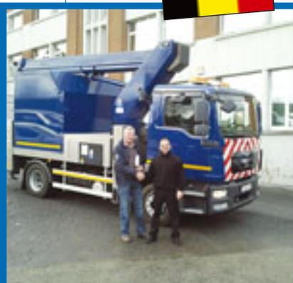
Rémy Doyen von Ruthmann (r.) übergibt einen 18-Meter-„Steiger“ T180.1 S9 an Jean-Marc Tarin vom Energieversorger AIESH mit Sitz im wallonischen Rance. Diese Maschine wurde an die Kundenwünsche angepasst, unter anderem mit Luftfederung hinten und 300 Kilo Korblast.
