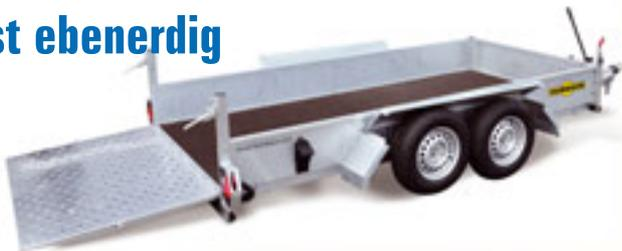
Humbaur bringt einen neuen Tandem-Absenkanhänger, der speziell für den Transport von Maschinen mit geringer Bodenfreiheit ausgelegt ist. Der „Senko“ verfügt über eine massive gebolzte Rahmen- und Bordwandkonstruktion aus drei Millimeter starkem Stahlblech. Hydraulisch absenkbar Achsen und die ein Meter lange Auffahrklappe helfen dabei, Maschinen mit geringer Bodenfreiheit fast ebenerdig aufzuladen. Für die nötige Sicher-
