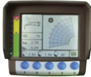
Das MCDC von Merlo bietet dynamische Lastkontrolle
