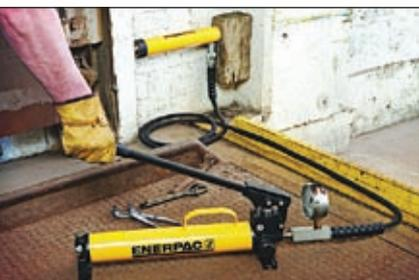
Enerpac stellt seine neuen ‚Power Serie. Ultima Stahlhandpumpen‘ vor, geeignet für anspruchsvolle Anwendungen. Ohne Abstriche in Bezug auf Geschwindigkeit oder Leistung hat Enerpac die Hebelkraft der Hochdruck-Stahlhandpumpen um 20 Prozent reduziert. Das innovative
