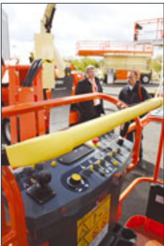
JLG setzt auf einen elektronischen Mechanismus, der vor dem Bedienpult eingebaut wird
