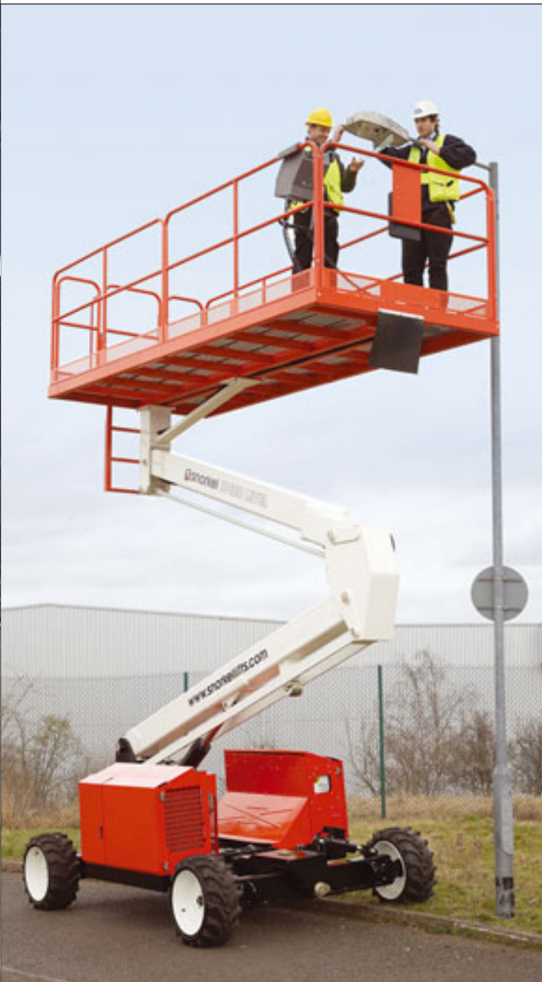
Die Speed Level von Snorkel können seitliche Neigungen bis zu 13 Grad ausgleichen
