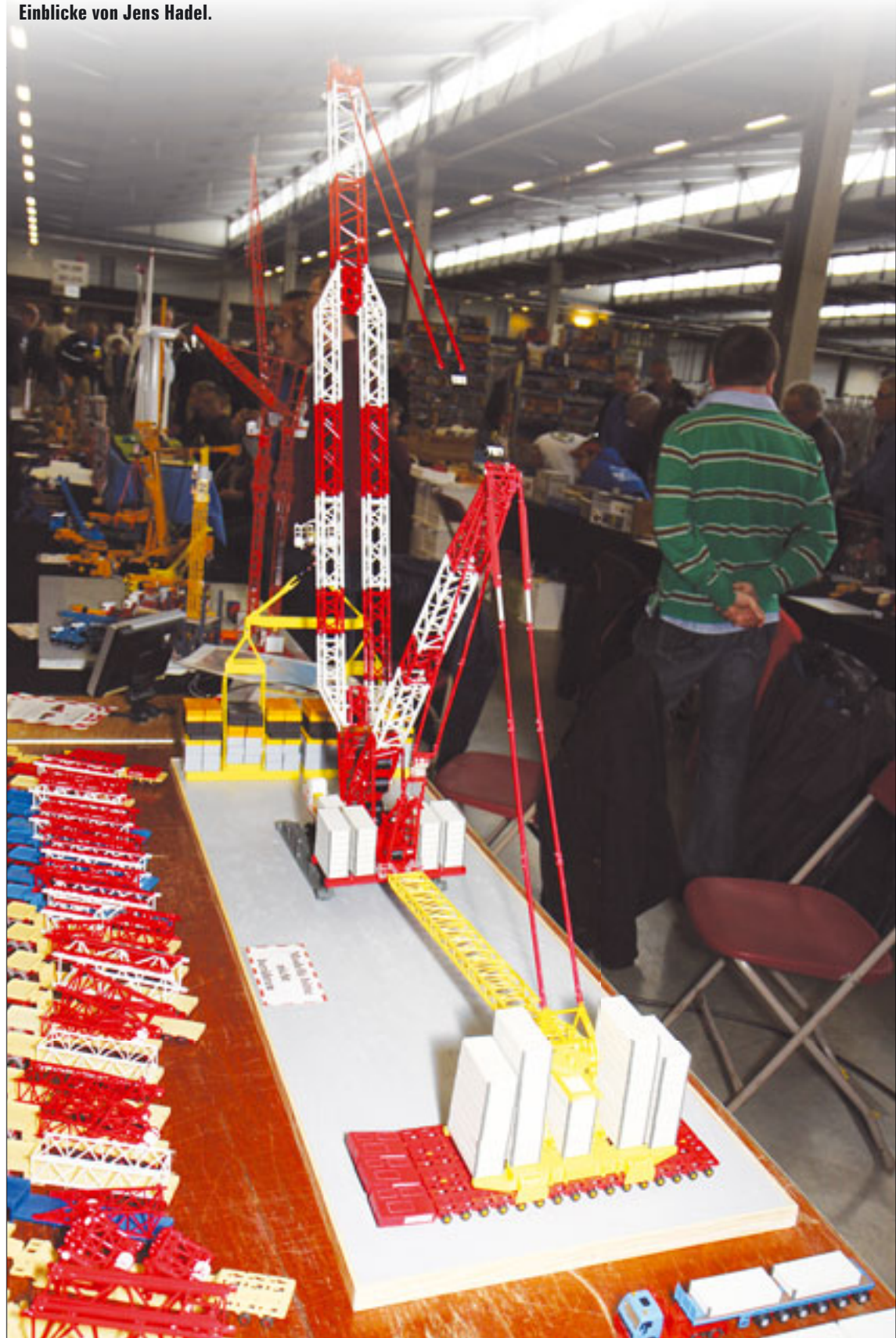
Die Powervariante des Liebherr LR13000 mit P-Boom legt den Schwebeballast auf SPMTs ab
