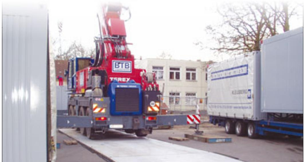
*Der Kran erhält durch die mobilen Platten einen sicheren und sauberen Einsatzort*
