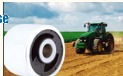
versetzt, fließt das hydraulische Medium durch die engen Kanäle im Inneren der Buchse. Der dabei erzeugte Strömungswiderstand ruft eine Gegenkraft zu der von außen eingeleiteten Verschiebung hervor. Durch diese hydraulische Dämpfung werden Vibrationen gemildert und der Komfort für den Fahrer erhöht.
