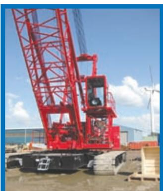
*Sonderlösungen von der Stange: Spezielle Einzellösungen bündelt Manitowoc nun unter dem Begriff „Hublösungen“. Ein spezielles Team unter der Leitung von Allen Kadow kümmert sich um die so genannten Lift Solutions (im Bild: eine höhere Kabine beim 2250), welche für Gittermast-Raupenkrane angeboten werden.*
