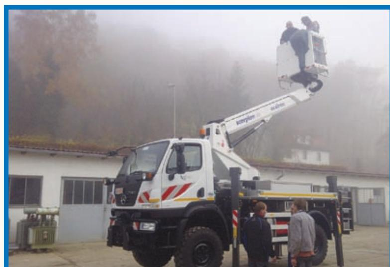
*Eine Oil&Steel Scorpion 15 E in Geländeausführung, aufgebaut auf einem Unimog, hat das Elektrizitätswerk Wörth/Donau in Empfang genommen. Geschäftsführer Rupert Heider sieht eine Vielzahl von Einsatzmöglichkeiten für sein Unimog-Unikat. Das Abstützen innerhalb der Fahrzeugkontur mit sehr langem Stützenhub ermöglicht sowohl das Arbeiten im laufenden Straßenverkehr als auch das Arbeiten im Gelände.*
