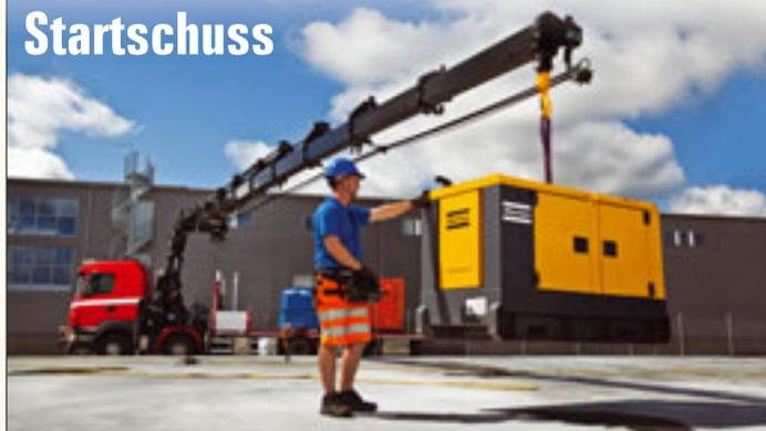
Hiab bringt seinen Ladekran XS 544 auf den Markt. Der 51mt-Kran bringt es auf eine maximale Reichweite zwischen 15 und 25 Metern, je nach Anzahl der Ausschübe. Mit 6 Ausschüben und Jib-Ausleger sind sogar 35 Meter Reichweite drin. Der Kran kommt daher mit dem „HiPro“-System für feinfühligere Steuerung, 360-Grad-Endlosdrehung, variablem Pumpensystem und verbesserten Verbrauchswerten. Sergio Peiró, Produktmanager
