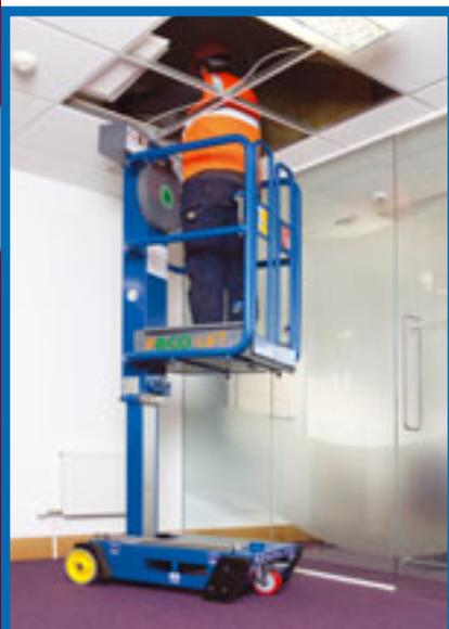
Power-Tower bringt den Peco-Lift jetzt auf den Markt. Der clevere Lift mit 3,50 Meter Arbeitshöhe wird wie gesagt komplett von Hand betrieben, ganz ohne Strom. Mit dem Schwungrad geht es über Druckluft nach oben. 975 x 700 Millimeter misst die Mini-Bühne, die lediglich 145 Kilogramm wiegt.
