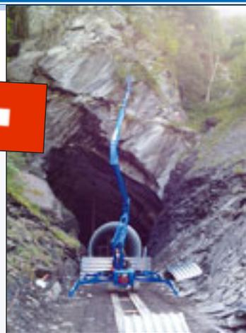
nach hinten, wodurch die Traccess optimal in engen Umgebungen oder auf Straßen arbeitet, schildert Gerber. Die Kran-Bühne bietet eine Hubhöhe von 20,5 Meter, verschiedenen Abstützvarianten und 250 Kilogramm Tragkraft im ganzen Lastdiagramm.
