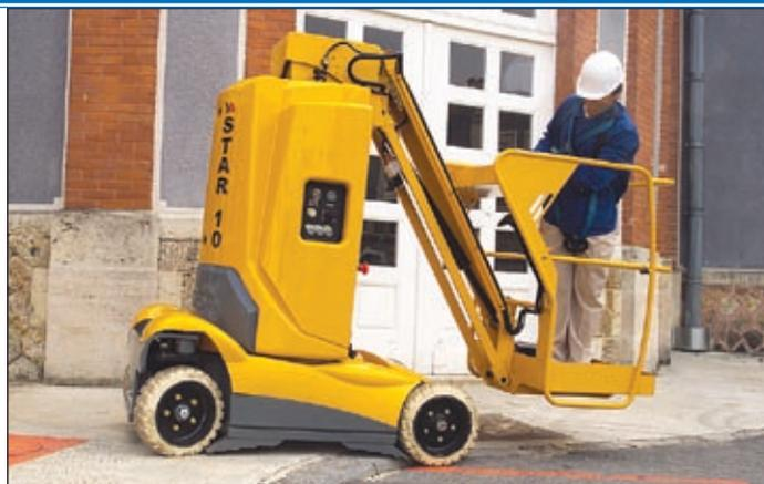
Der Stern unter den Haulotte-Modellen, die Star 10 mit zehn Meter Arbeitshöhe
