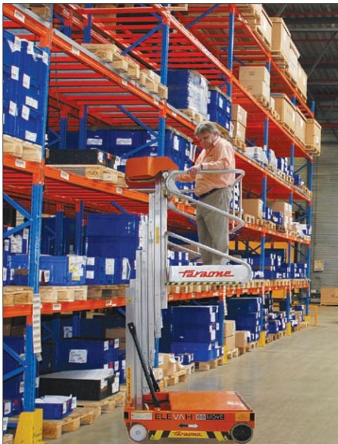
Der „Elevah 65 Move“ von Faraone mit Aluminiumteleskopmast
