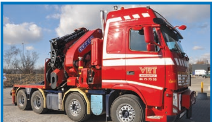
Den neuen Efferkran 1405 8S + JIB 6S HD erhält die Zimmerei Prosch aus Nürnberg. Der Effer-Partner Westa baut den Ladekran auf ein MAN-Chassis des Typs TGS 35.540 8x6H BL hinter der LKW-Kabine auf.
