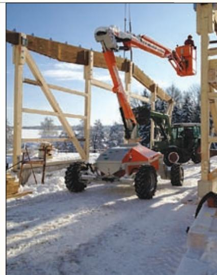
Korb noch näher an den Einsatzbereich heranfahren. Die maximale Neigung des Untergrunds kann die Geländearbeitsbühne bis 17 Prozent in Längsrichtung und 30 Prozent in Querrichtung durch Selbstnivellierungsachsen ausgleichen.
