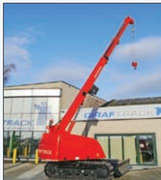
Das Testzentrum de Lille, Hersteller des Giraf Track, hat mittlerweile die Produktion der Kranversion gestartet. Den ersten Giraf Track GT3C hat das Unternehmen an den Schweizer Arbeitsbühnenvermieter Airnace mit Sitz in Avionnaz geliefert. Die Maschine ist mit einem hydraulisch verstellbaren Ausleger ausgestattet.
