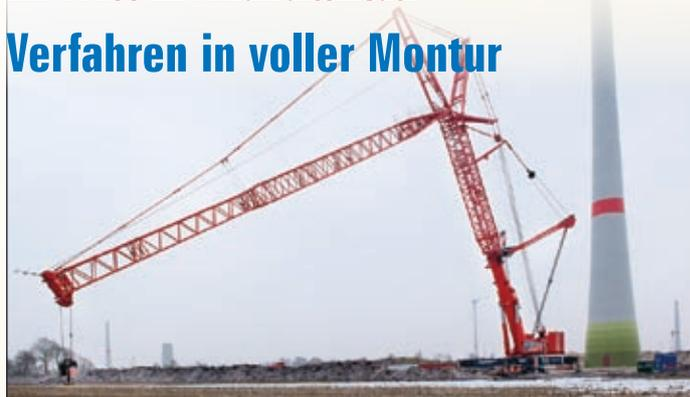
510 Tonnen geballte Hebetechnologie schieben sich auf zwei Raupenfahrwerken über einen gerade mal fünf Meter breiten Baustellenweg: ein Liebherr Teleskop-Raupenkran vom Typ LTR 11200, der sich hier auf schmalen Fahrweg zum nächsten Baufeld bewegt. Mit eintelekopiertem Hauptmast, 54 Meter langer Wippspitze und 182 Tonnen Ballast verfährt der mobile Großkran in vollem Rüstzustand innerhalb weniger Stunden zwischen zwei Windkraft-Baustellen. Zusammen mit einem zweiten
