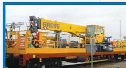
*Fremd gegangen: Der Oberwagen eines 30-Tonnen-Geländekrans vom Typ Grove RT530E-2 wurde auf einem Eisenbahnwagen montiert. Diese ungewöhnliche Kombination kommt bei der Montage von Oberleitungen im belgischen Schienennetz zum Einsatz. Achsen und Fahrwerk mussten entfernt und das Gegengewicht durch ein kleineres ersetzt werden. Auf drei Metern hebt der Kran immer noch 14,3 Tonnen.*
