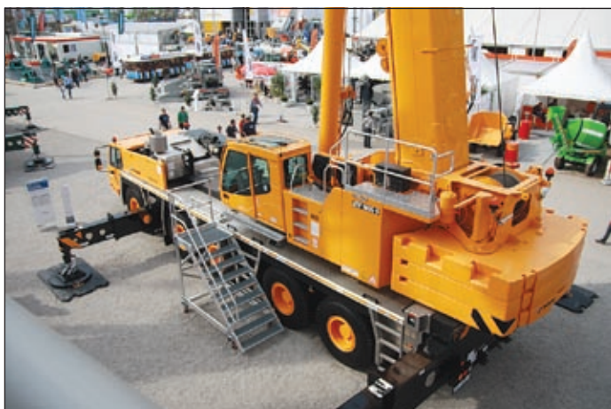
Tadano Fauns jüngster Neuzugang ist der ATF180-G5 mit 180 Tonnen Tragkraft
