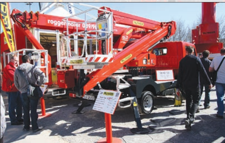
Die neue P 200 A von Palfinger mit ihrer hydraulischen Steuerung zielt auf den Massenmarkt. Das Pendant, zumindest das untere Turmsegment, ist daneben zu sehen und gehört zur neuen „P 900 TopClass“.
