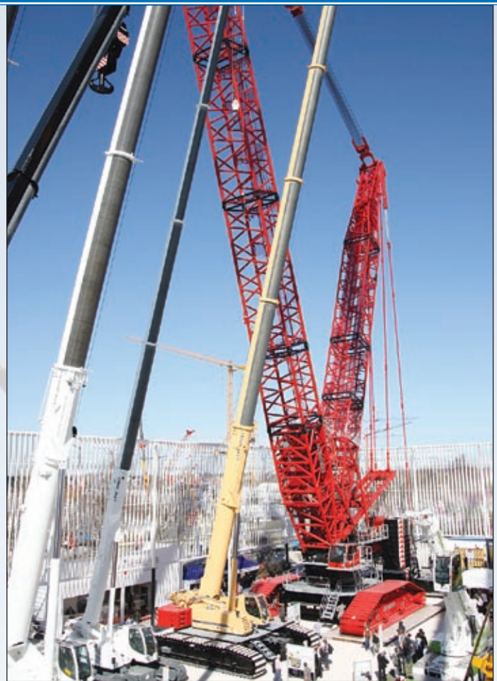
Über den neuen 1.000-Tonnen-Raupenkran LR 11000 von Liebherr war im Vorfeld nicht viel zu erfahren. Umso größer war das Interesse an dem Gerät auf der Messe.
