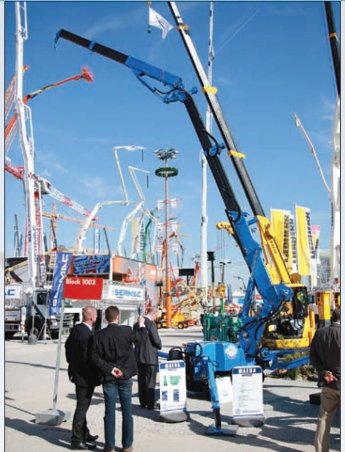
Ein Knick an der richtigen Stelle: Der neue Maeda Minikran MK 1033 C bietet so eine „Up & Over“-Funktion
