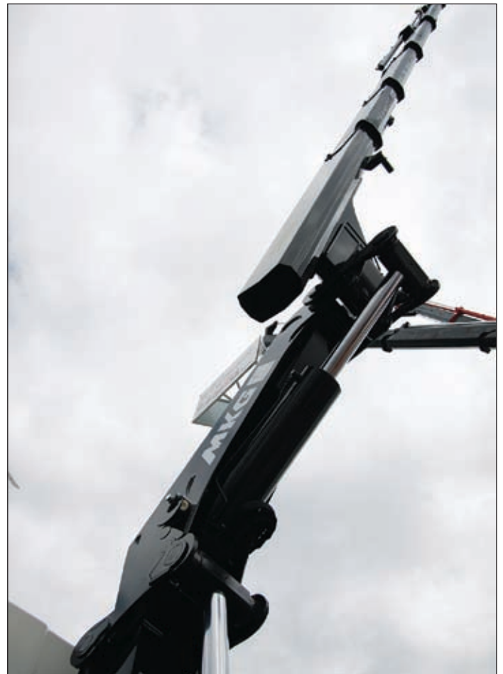
Bei seinen Modellen setzt MKG auf 8-fach gekantete Profile
