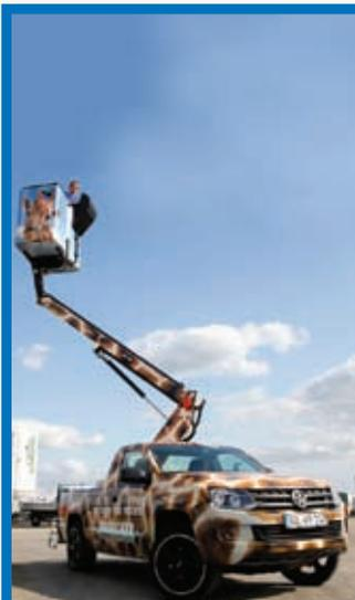
Mit innovativer Fahrzeugbeschriftung ein absoluter „Eye-catcher“: Die neue Giraffe Versalift-Arbeitsbühne LT 110 der Wiesacker Werkzeugvermietung ist auf einem 3,5-Tonnen-Amarok-Chassis aufgebaut und kann auch von Inhabern der Führerscheinklasse B gefahren werden. Und: Wiesacker kann den Amarok auch ohne Versalift-Aufbau einsetzen. In Minutenschnelle kann Arbeitsbühne von der Ladefläche des Amarok „entdockt“ werden.
