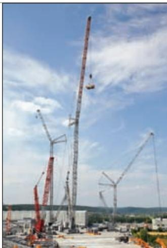
etwa 600 Kleinwagen in einem Hub. Eine verrückte Vorstellung, die die Dimensionen des neuen Raupenkrans aus Ethingen annähernd verdeutlicht. Für den Weltrekord wurde der LR 13000 mit 400 Tonnen Drehbühnenballast und sage und schreibe 1.500 Tonnen Derrickballast auf einem Spezialfundament aufgerüstet.
