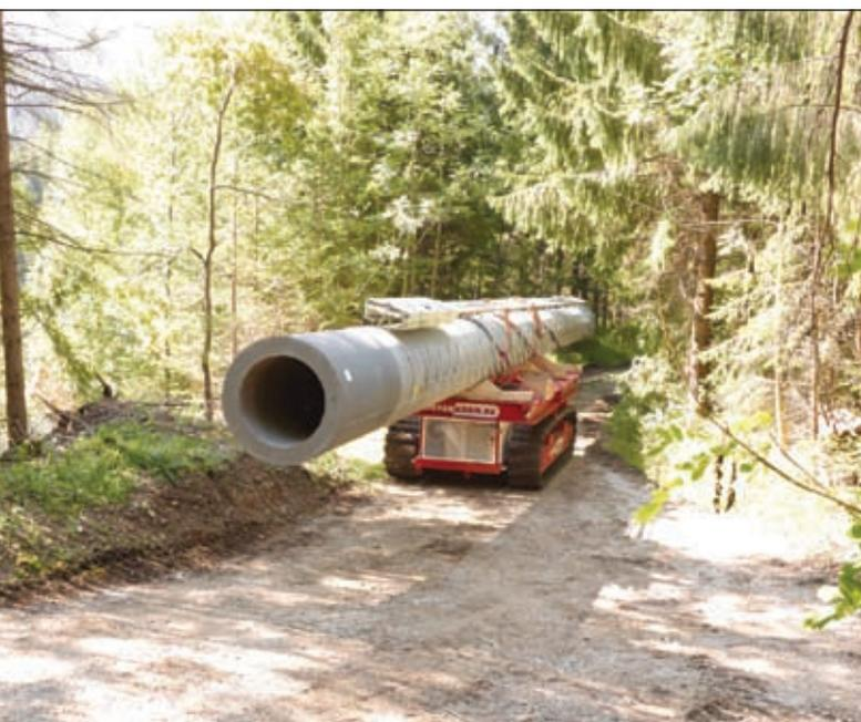
Im Betriebsmodus „Direktladung“ werden die Turmsegmente des Mobilfunkmastes durch das unwegsame Gelände gebracht
