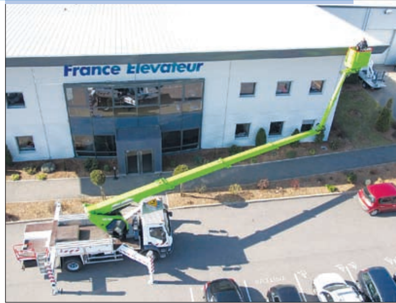
Auf doppelte Isolation gegen 1.000 Volt und optional Elektroantrieb setzt France Elevateur mit den Modellen TBE 263 (im Bild) und TBE 283
