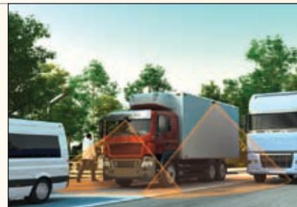
onen zusammen in einem Bild aus der Vogelperspektive darstellen. Da Mauervorsprünge, Hausecken und andere Fahrzeuge angezeigt werden, beschleunigt es beispielsweise auch Rangiervorgänge.
