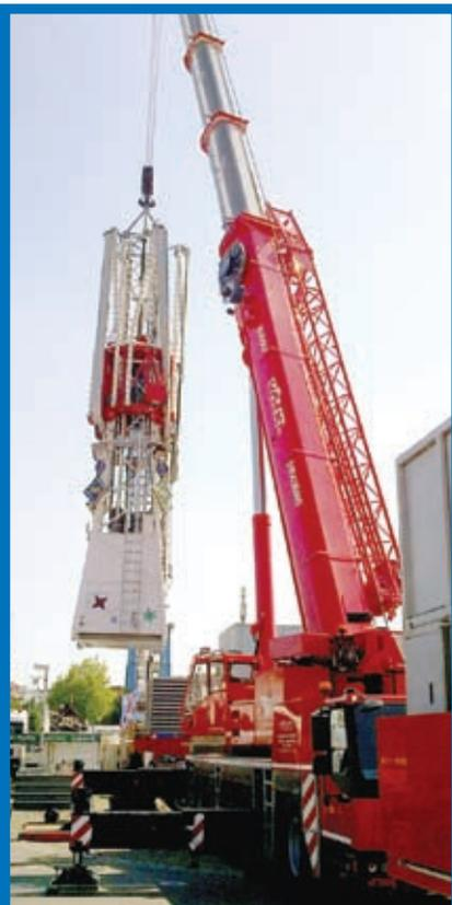
Rakete montiert: Der neue 220-Tonner GMK5220 von Völkl aus Straubing hat seinen ersten Einsatz beim Gäubodenvolksfest absolviert, wo er zwei Fahrgeschäfte aufgebaut hat. Eines davon, die „Rakete“, ist ein 64 Meter hoher Turm, dessen Bestandteile mehr als 28 Tonnen wiegen.
