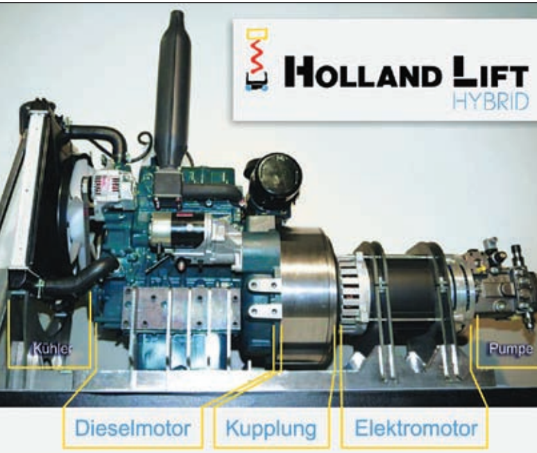
So ist der neue Hybridantrieb von Holland Lift aufgebaut
