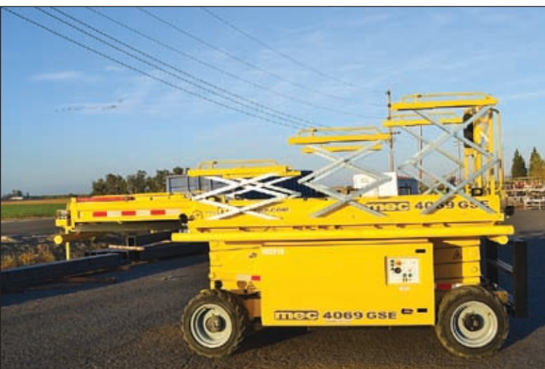
Speziell auf die Bedürfnisse der Luftfahrt hat MEC seine neue Scherenbaureihe mit variablem Geländer abgestuft
