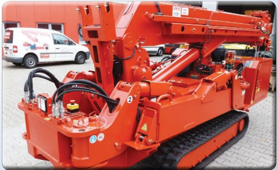
B-506-5.1: Diese Sonderanfertigung hebt 0,8 Tonnen bei 18 Meter Hubhöhe auf fünf Meter Arbeitsradius
