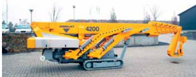
Ein Teleskop auf Raupenketten mit 42 Metern Arbeitshöhe wird Omme Lift in Kürze als Neuheit präsentieren. Die 4200 RBDJ wird hybrid angetrieben, kommt auf eine Reichweite von 15,2 Meter und ist die bislang größte Teleskop-Raupe im Portfolio der Dänen. Das Gerät verfügt über einen Korbarm; er kann bis zu 130 Grad abgewinkelt werden. Um die 6.800 Kilogramm wiegt die Bühne. Dank des Diesel/Batterie-Antriebs kann die Raupe innen und außen eingesetzt wer-
