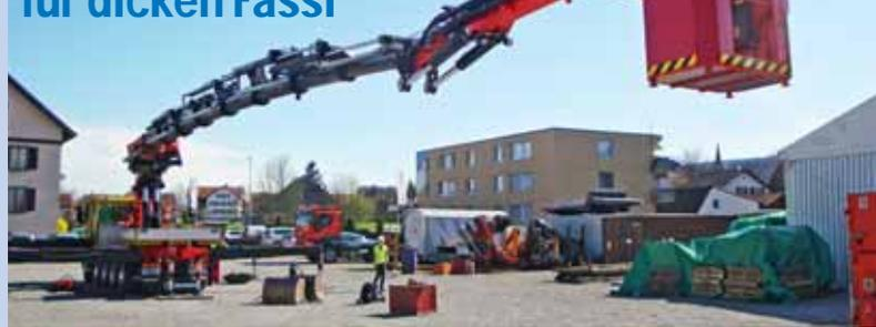
Schwieriges Gelände, extreme Höhen – es gibt eine Reihe von Anwendungen, bei denen Arbeitsbühnen passen müssen. Abhilfe bietet seit kurzem der Fassi-Ladekran F1950RA.2.28 mit JIB 816L, welchen die Firma Caduff für den Betrieb mit Arbeitskorb zertifiziert hat. Bis in Höhen von 38 Metern und Weiten von 36 Metern lassen sich zwei Personen mit Werkzeugen und Material, mit einem Gesamtgewicht von 300 Kilogramm
