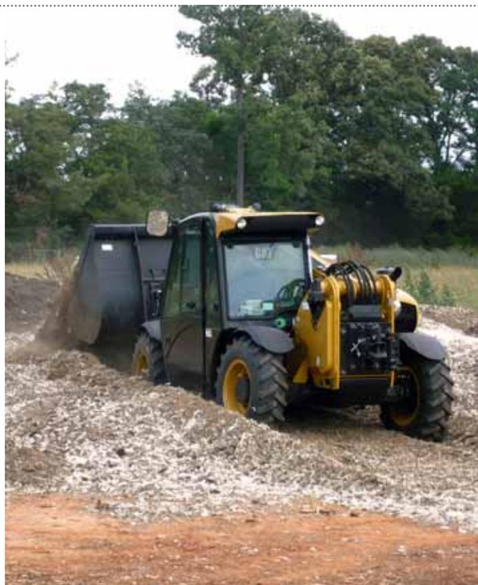
>> Caterpillar bringt den neuen kompakten Teleskoplader TH255C auf den Markt. Er bietet eine Hubhöhe von maximal 5,6 Meter und eine Hubkapazität von bis zu 2,5 Tonnen. 1,90 Meter misst der hydrostatisch angetriebene Kompakte in der Höhe, 1,80 Meter in der Breite und bringt dabei knapp fünf Tonnen auf die Waage.
