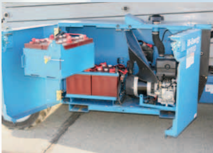
Die Genie-Neuheit bietet einfachen Zugang zum Akkupack
