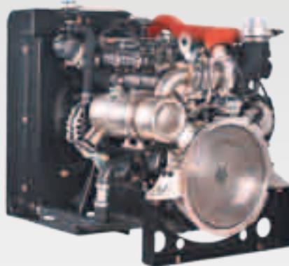
Hatz bietet seinen wassergekühlten Dieselmotor 4H50TIC als einbaufertige „Open Power Unit“ an. Der Motor erfüllt die Abgasvorschriften der Stufe IIIB in der EU, sowie EPA Tier 4 final in den USA. Das Komplettsystem beinhaltet den Motor sowie sämtliche zur Kühlung benötigten Teile. Der Kunde muss lediglich Armaturenkasten, Kraftstoffleitungen und Batterie bereitstellen. Das System eignet sich zum Beispiel für bei-
