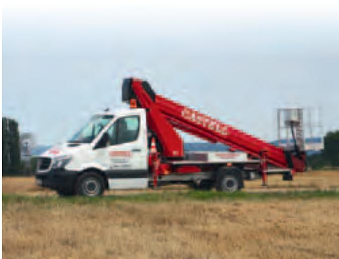
» 27 Meter für Castell: Der Koblenzer Arbeitsbühnenvermieter hat einen neuen „Steiger“ TB270 von Ruthmann übernommen. Neben dem Dieselmotor hat die Bühne auch ein Aggregat zum Betrieb mit 230 Volt an Bord, um in der Innenstadt oder in geschlossenen Räumen sauber und geräuscharm zu arbeiten.
