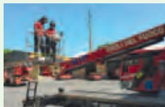
↑ Die Feuerwehr im italienischen Lucca hat sich für eine LKW-Bühne aus italienischer Produktion entschieden: einen B-Lift 187 des Herstellers **CTE**. Die Anschaffung der 18-Meter-LKW-Bühne wurde mit Spenden einer Stiftung finanziert. Die Bühne bietet 12,7 Meter maximale Reichweite und kann 250 Kilogramm im Korb mitführen.
