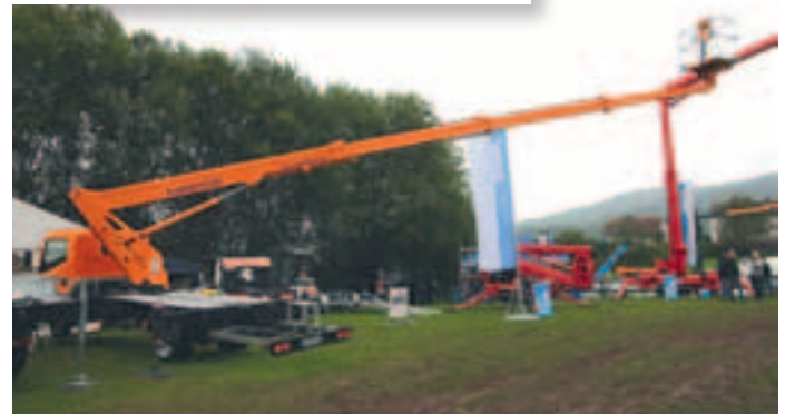
Blumenbeckers neue HM 25 TVA hat mit 80 Kilo im Korb eine Auslage von 14,8 Meter, mit 200 Kilogramm um die zehn Meter
