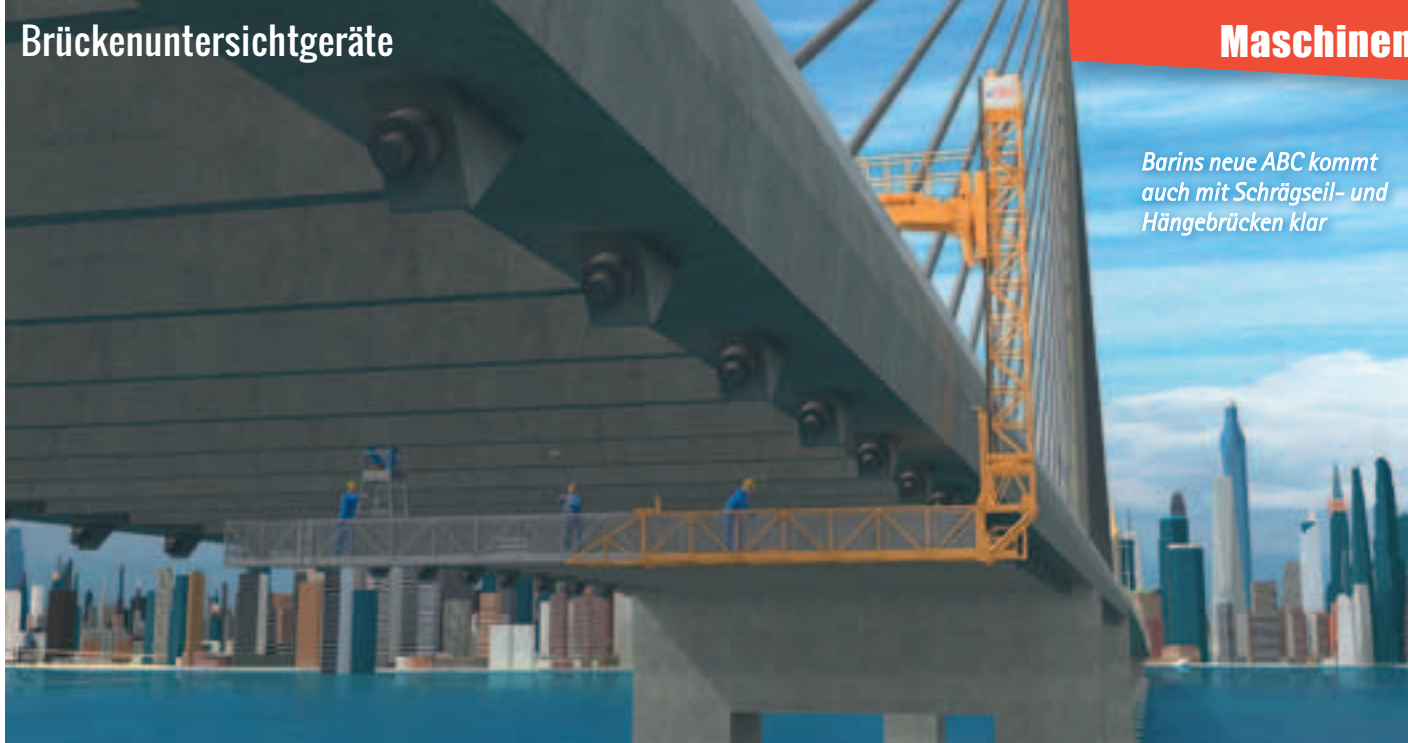
Ein MBI 140 mit erhöhtem Übergriff und 16 Meter Reichweite unter der Brücke lieferte Moog an Brügger
