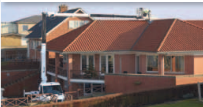
24 Meter Arbeitshöhe auf 3,5 Tonnen: Die VTX-240 von Time Versalift ist heckseitig aufgebaut und mit einem Gelenk ausgestattet
