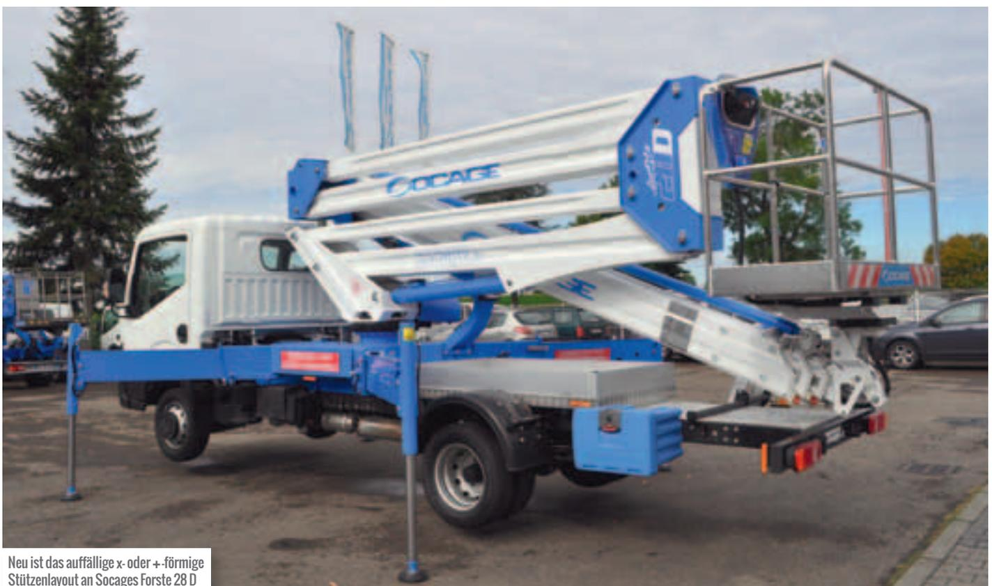
Neu ist das auffällige x- oder +-förmige Stützenlayout an Socages Forste 28 D
