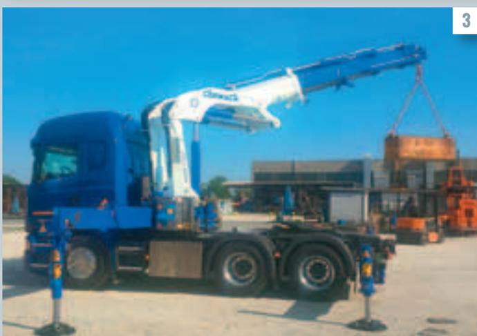
Eine ganze Reihe neuer Krane aus dem Bereich der L-Krane, Z-Krane und K-Krane hat jetzt HMF vorgestellt. Dazu zählen gleich zwölf neue Knickarm-Krane in der Version TX+ mit Lastmomenten zwischen 11 und 26 mt. Im Vergleich zu den Vorgängermodellen arbeiten die Neuheiten mit einem erhöhten Arbeitsdruck, der von 330 auf 345 bar gesteigert werden konnte. In Verbindung mit verbesserten Stahllegierungen
