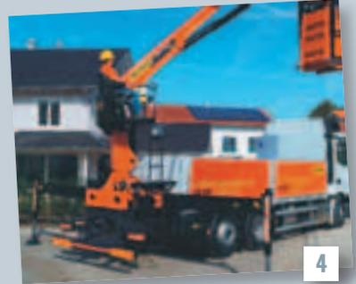
Ebenfalls neu ist der F85B.0, der im 8-9 mt Bereich angesiedelt ist. Der F85B bietet die Möglichkeit, hydraulische Verlängerungen bei jeder Version (Standard, Extra, Super-Extra, Iper-Extra) einzusetzen, ohne den Querträger verändern oder die Stützen auswechseln zu müssen. Den Kran gibt es mit einer, zwei, drei oder vier hydraulischen Verlängerungen. Die maximale hydraulische Ausladung beträgt 11,5 Meter, während die Hubkapazität 9,2 tm beträgt.
