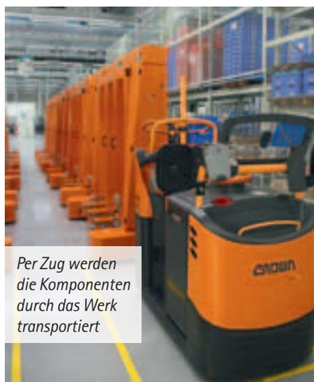
Per Zug werden die Komponenten durch das Werk transportiert
