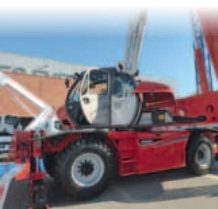
Manitou hat einen neuen drehbaren Teleskoplader mit 32 Meter Hubhöhe enthüllt. Der neue Roto trägt die Typenbezeichnung MRT 3255, kann bis zu 5,5 Tonnen heben und erreicht eine Hubhöhe von 31,6 Meter. Unter der Motorhaube steckt ein Mercedes Tier IV Dieselmotor in Verbindung mit einem stufenlosen Getriebe von Dana. Von der Steuerung über die Abstützung bis hin zur Kabine weist der MRT 3255 allerhand Neuerungen auf, so der Hersteller. <<
